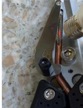
触媒側を上にして、刃の黒いつまみを回して、サスカバーを半分開く。触媒(発熱部)が見えますか？
