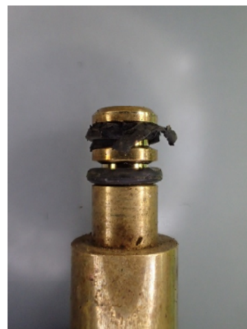
オーリング破損→交換
