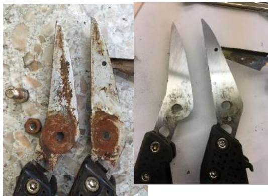
カシメ部の錆び・動かない→掃除・刃の交換
