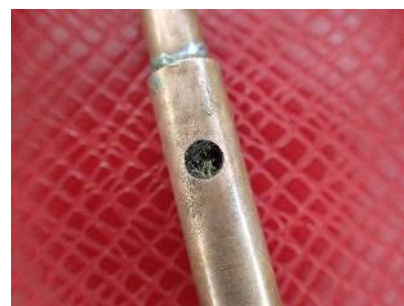
銅パイプ詰まり→エアガン
